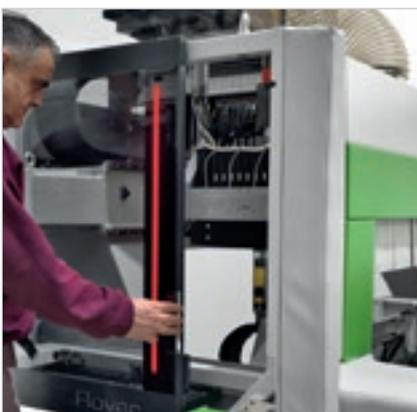
El **carenado frontal se puede abrir** para facilitar el acceso durante las operaciones de montaje de herramientas.
