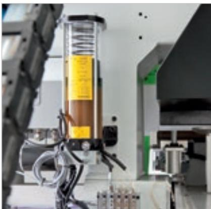
La **lubricación automática** garantiza la lubricación continua de los principales órganos de movimiento de la máquina sin necesidad de que intervenga el operario.
