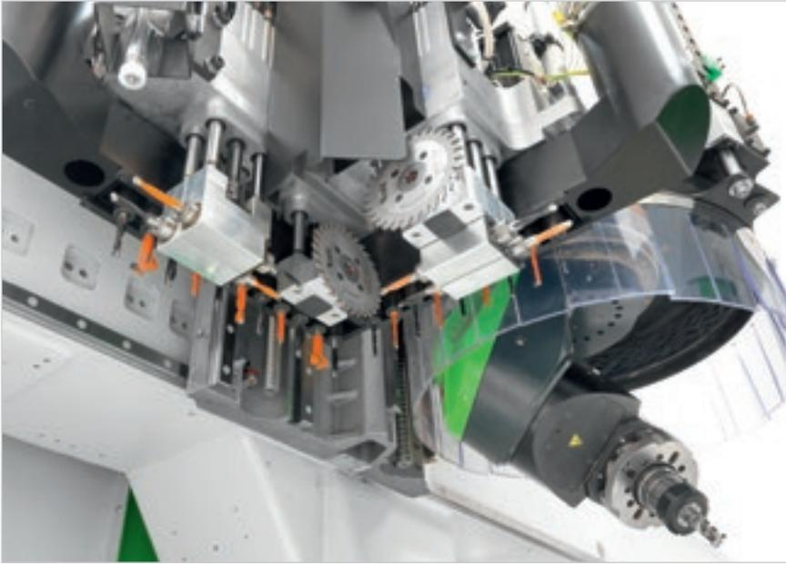
El tamaño compacto del quinto eje, combinado con la alta capacidad de taladrado, permite abarcar cualquier rango de producción, desde los mecanizados de geometrías simples hasta los más complejos.
