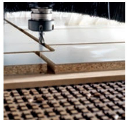
Dos máquinas en una: todas las funciones y la calidad de una auténtica mesa pantógrafo están garantizadas por el **CFT (Convertible Flat Table)**, permitiendo mecanizados de paneles finos, nesting y folding en una máquina con mesa de barras.
