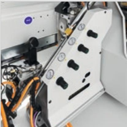
Fiabilidad y precisión de corte gracias al **Grupo Encabezador** dotado de dos motores con deslizamiento sobre 2 guías lineales, para eliminar la parte sobrante del borde en la cabeza y en la cola del panel.
