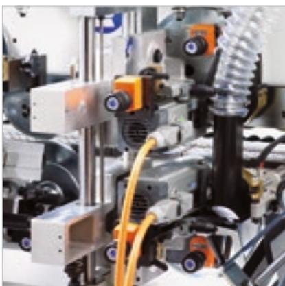
El **Grupo Rebordeador Superpuesto** reduce la parte sobrante del borde en la parte superior e inferior del panel. Garantiza el acabado del bloque en una sola pasada.
