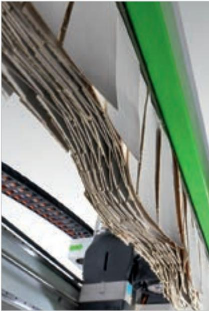
**Bandas laterales** para proteger el grupo operador, móviles para trabajar con la máxima velocidad con total seguridad.
