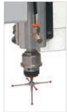
**El palpador de cruz** permite medir con la máxima precisión las dimensiones del panel.
