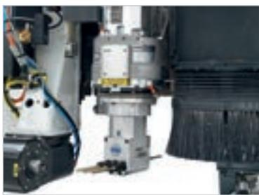
El grupo multifunción, posicionable en continuo a 360° desde el CN, puede montar agregados para la ejecución de trabajos específicos (alojamientos para cerraduras, fresados para bisagras, taladros horizontales profundos, retestado, etc.).
