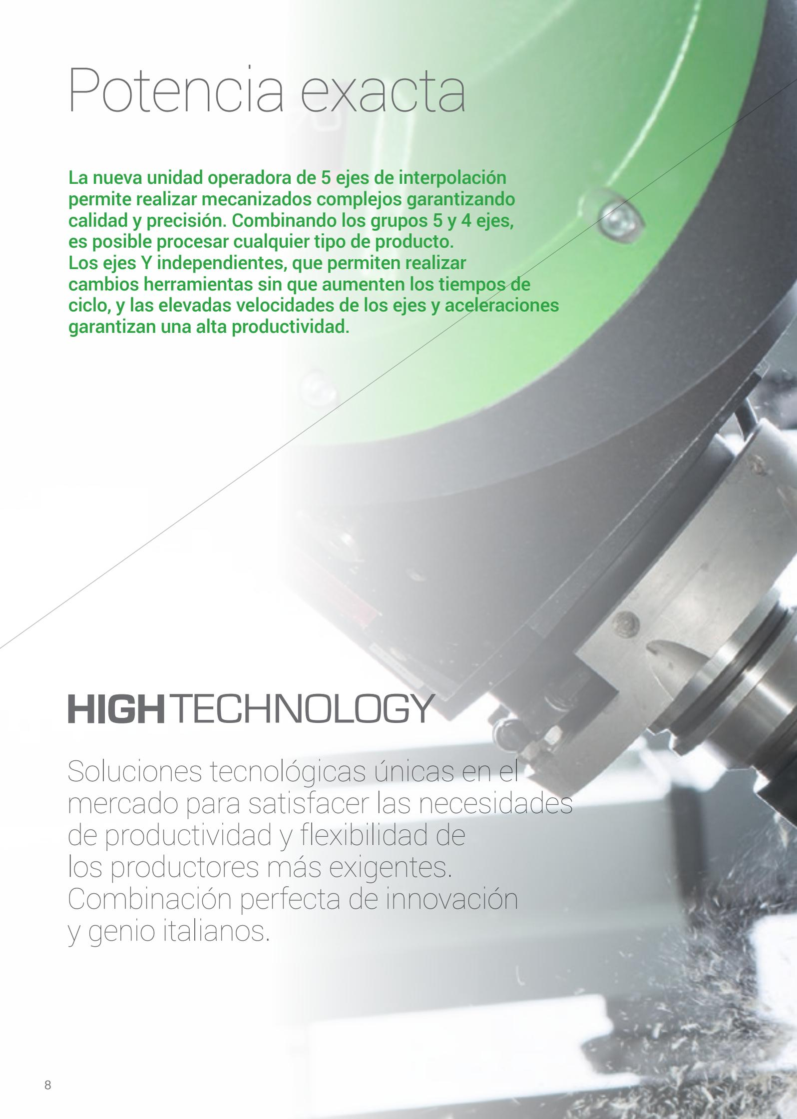
La nueva unidad operadora de 5 ejes de interpolación permite realizar mecanizados complejos garantizando calidad y precisión. Combinando los grupos 5 y 4 ejes, es posible procesar cualquier tipo de producto. Los ejes Y independientes, que permiten realizar cambios herramientas sin que aumenten los tiempos de ciclo, y las elevadas velocidades de los ejes y aceleraciones garantizan una alta productividad.
