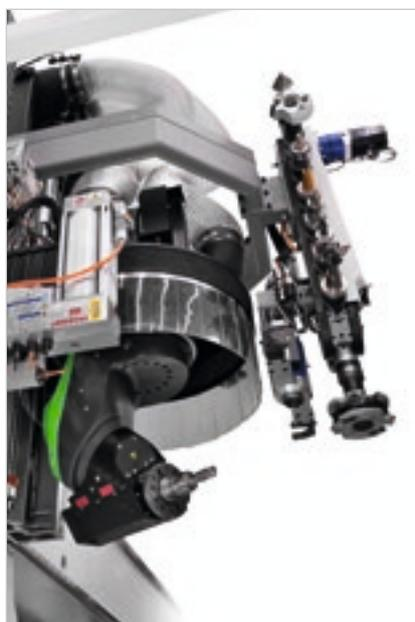
**Almacén de herramientas de cadena vertical** en el eje Y de 10-15 posiciones.
