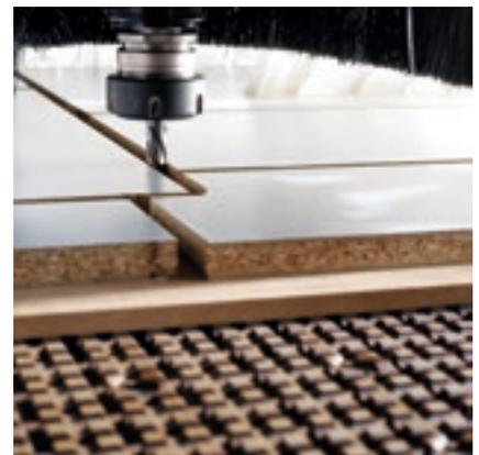
Dos máquinas en una: todas las funciones y la calidad de una auténtica mesa pantógrafo están garantizadas por la mesa de trabajo **CFT (Convertible Flat Table)**, permitiendo mecanizados de paneles finos, nesting y folding en una máquina con mesa de barras.
