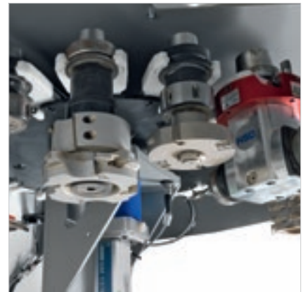
Almacén de herramientas de Revolver de 16 plazas sobre el carro X para disponer en cualquier momento de las herramientas y los agregados. Dotado de cobertura de protección de las herramientas de apertura automática.
