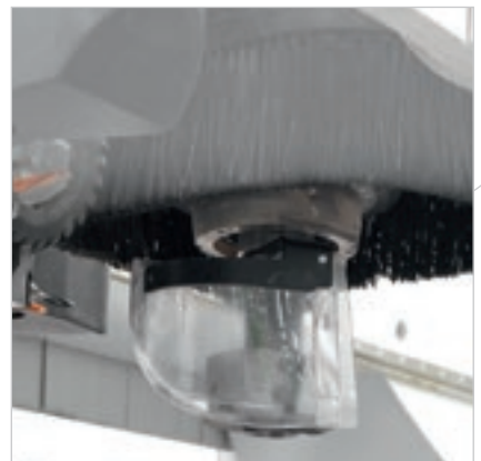
Deflector integrado (encauzador de virutas) gestionado por control numérico.
