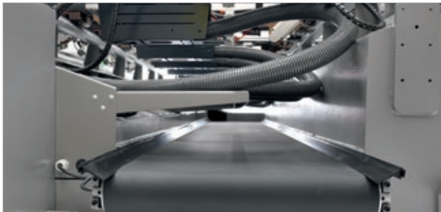
Tapete motorizado para eliminar virutas y restos.
