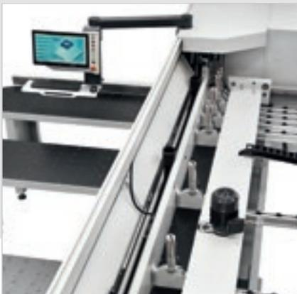
El prensor tiene una estructura que ofrece una presión homogénea y controlada sobre el paquete de paneles que debe cortarse.
