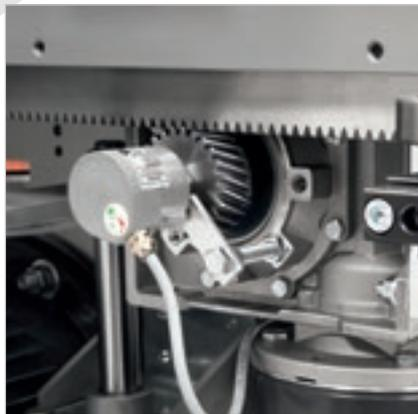
La geometría helicoidal del sistema piñón-cremallera garantiza una traslación del carro portasierras lineal y sin vibraciones en cualquier condición de trabajo.
