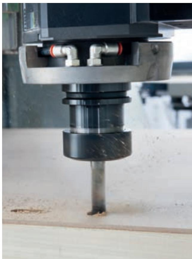
El centro Rover K Smart está dotado con 3 o 4 ejes independientes y de interpolación, y se puede equipar con agregados para poder realizar cualquier tipo de mecanizado tanto en paneles como en elementos de madera maciza.
