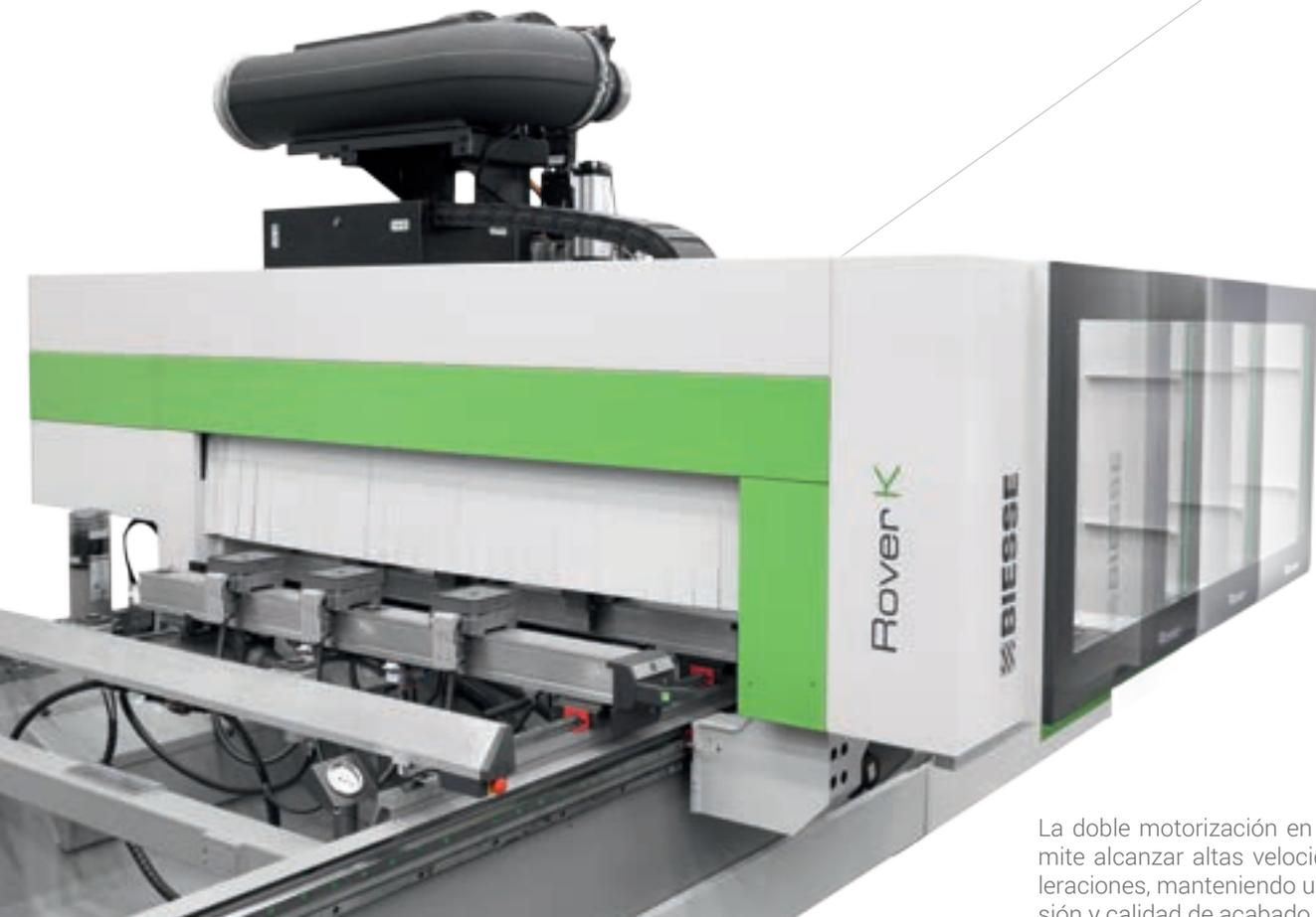
La doble motorización en el eje X permite alcanzar altas velocidades y aceleraciones, manteniendo una alta precisión y calidad de acabado.
