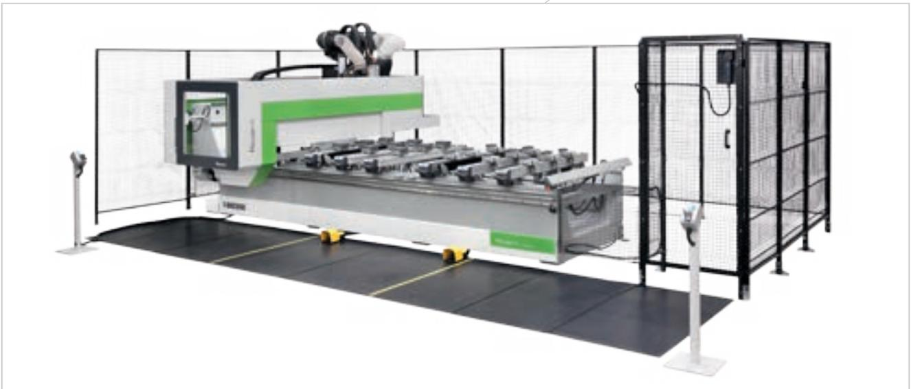
Seguridad activa gracias a las plataformas sensibles: la máquina sigue trabajando siempre a velocidad máxima y constante incluso cuando está bajo el control del operario.
