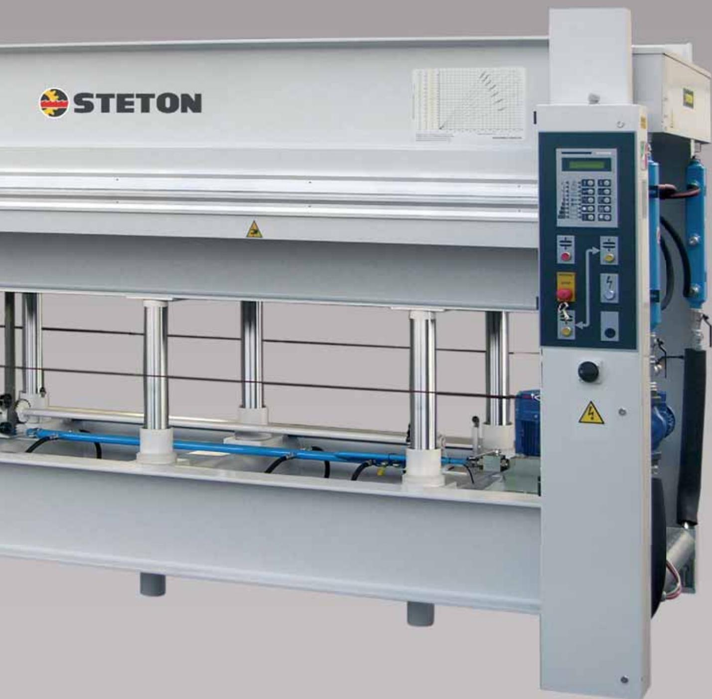
**Nella foto:** P 120 con boiler elettrico ad olio e programmatore elettronico (opzionale)
