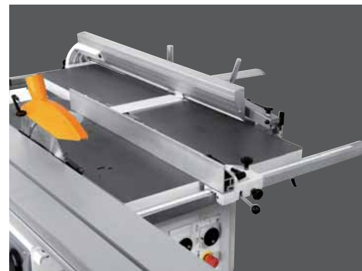
mesa suplementaria sobre el carro deslizante Para el soporte de tableros de gran tamaño.
